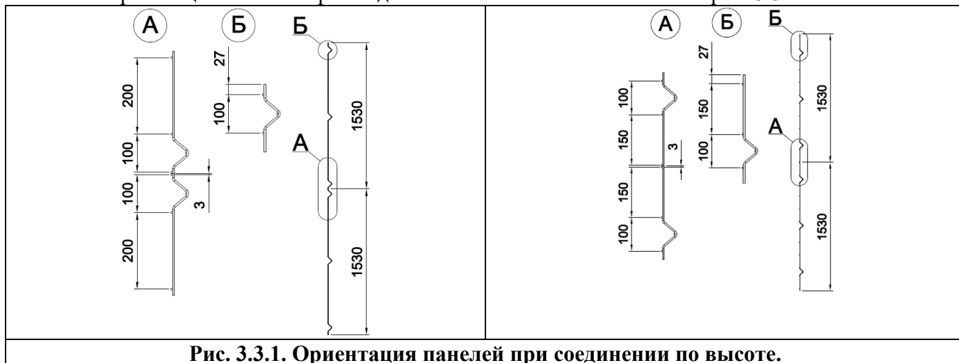
Рис. 3.3. Соединение панелей по высоте скобами СП-379
